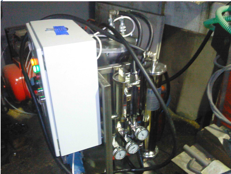
Установка ФКС-03-2. Очистка гидравлического масла станка гидроабразивной резки. Картридж магнитного фильтра с уловленным шламом.
